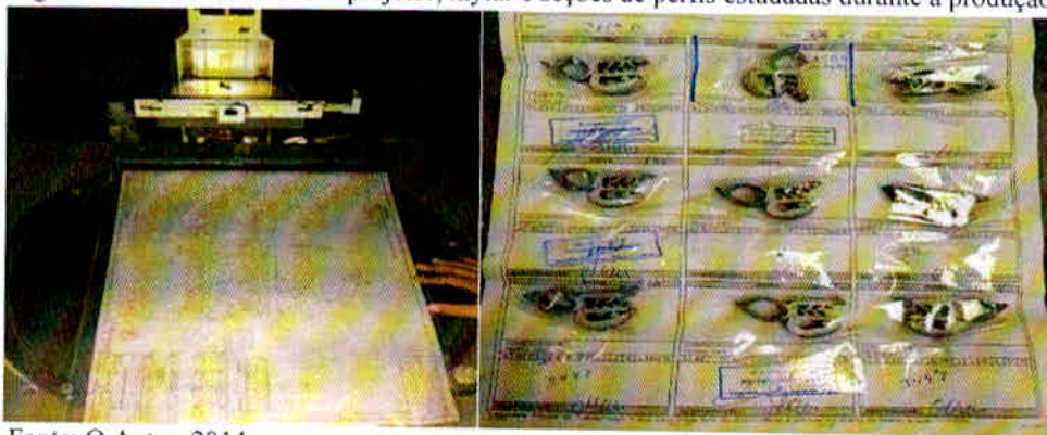
Figura 2 – Cabine de luz com projetor, mylar e seções de perfis estudadas durante a produção
