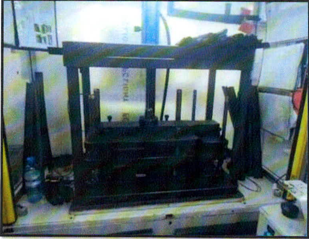
Figura15: imagem da haste do cilindro quebrado, e cabeçote caído.
