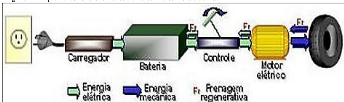
Figura 4 - Esquema do funcionamento do veículo elétrico a bateria.
