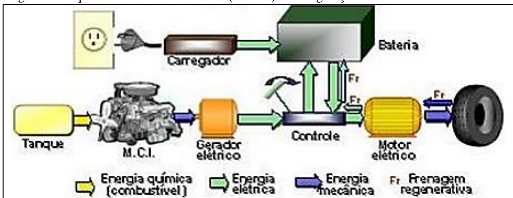
Figura 5 - Esquema do funcionamento do (VEHPs) – configuração em série.
