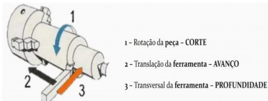
Figura 11 - Processo de torneamento.
