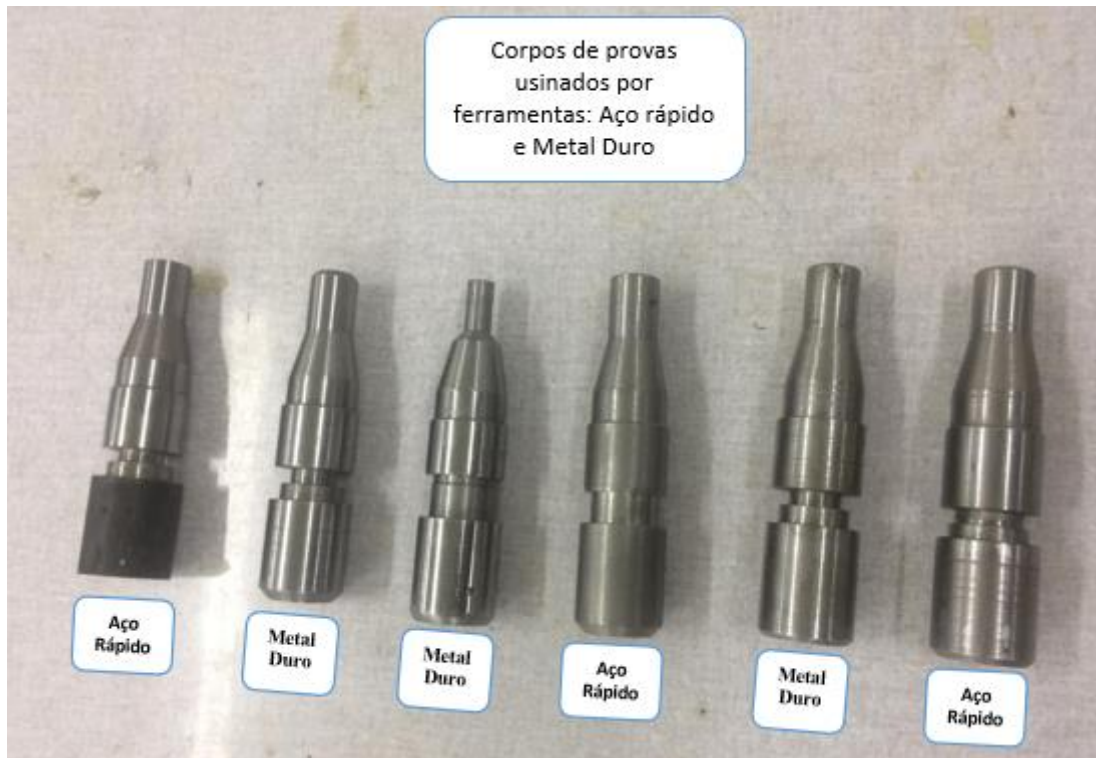
Figura 20 - Corpos de provas, comparativos de ferramentas.
