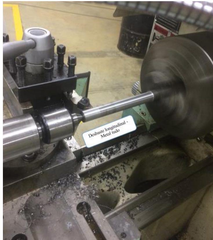
Figura 24 - Usinagem corpo de prova – Metal Duro
