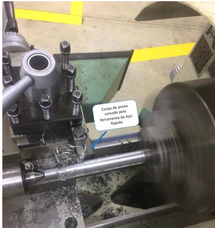
Figura 22 - Desbaste longitudinal – Aço Rápido.
