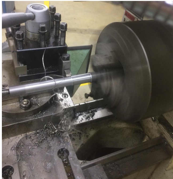
Figura 23 - Desbaste longitudinal – Aço Rápido.
