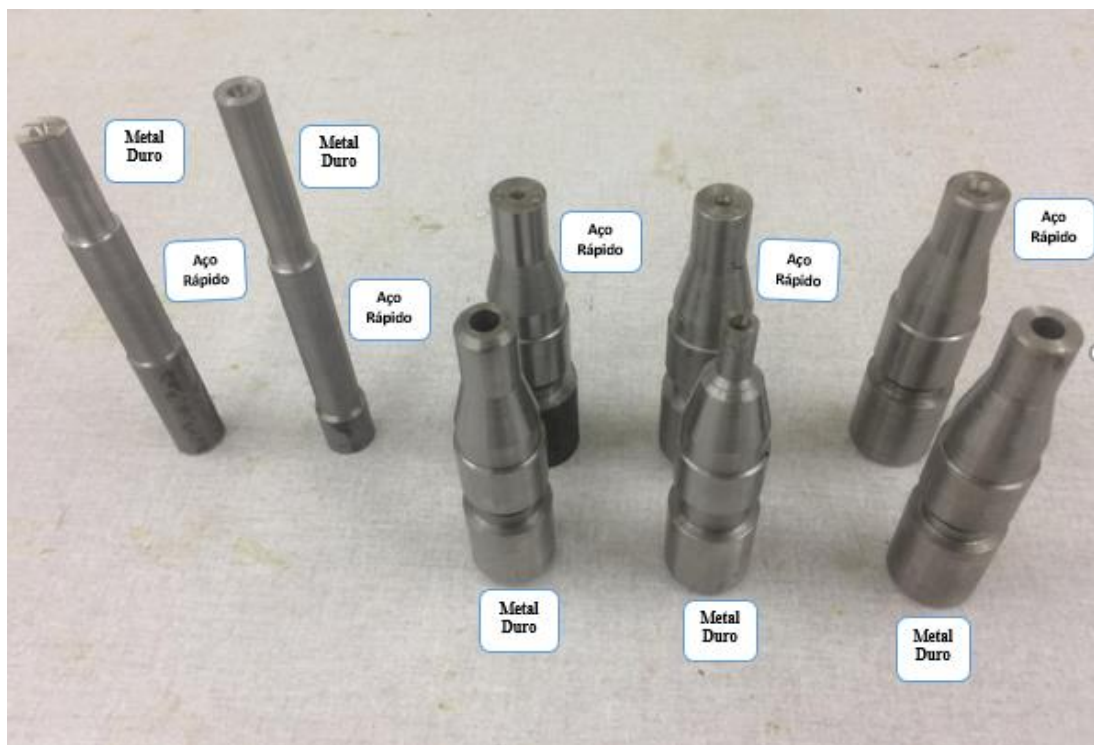
Figura 21 - Corpos de provas, comparativos de ferramentas.
