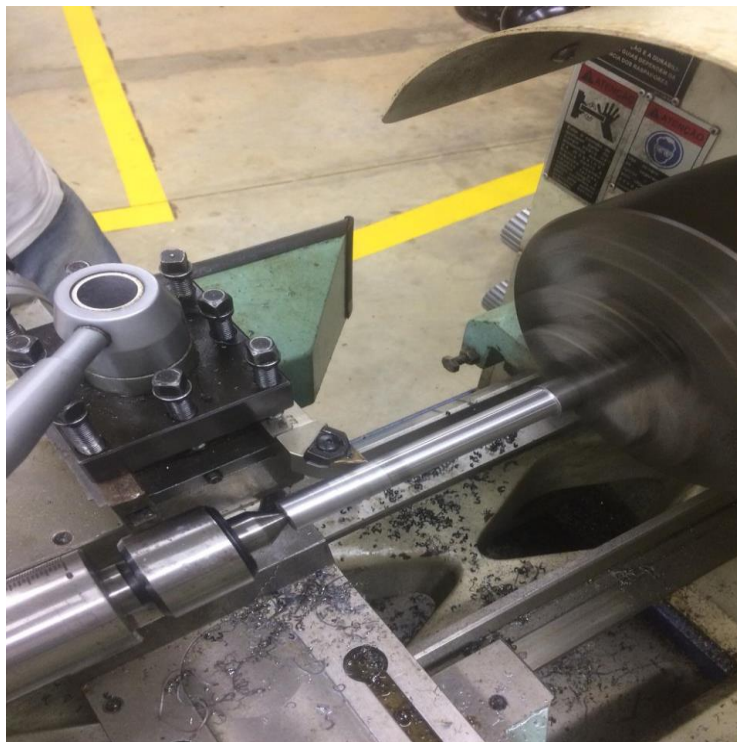
Figura 25 - Usinagem corpo de prova – Metal Duro.
