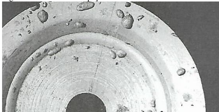
Figura 5 - Bolhas de ar na peça
