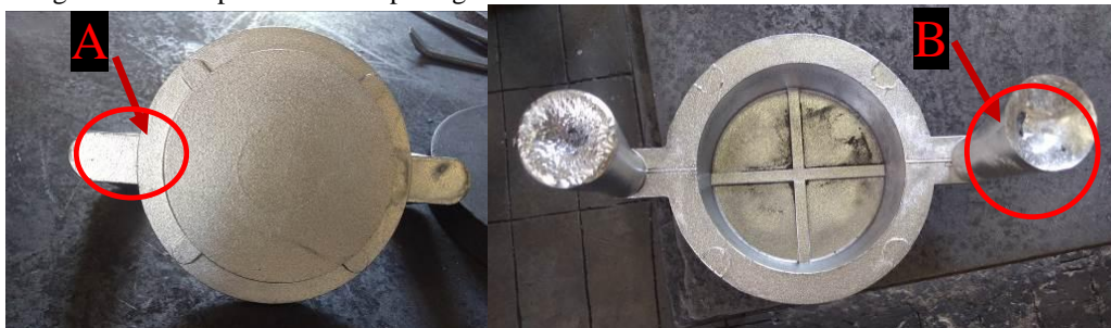
Figura 11 - Tampa da caixa de passagem em seu estado bruto
