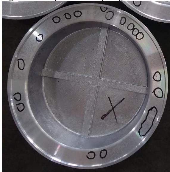
Figura 22 - Tampa da caixa de passagem referente a amostra 4
