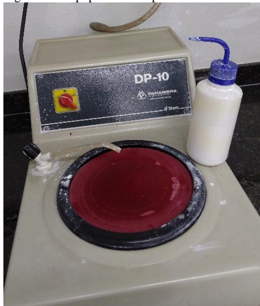
Figura 15 - Equipamento de polimento e frasco com alumina
