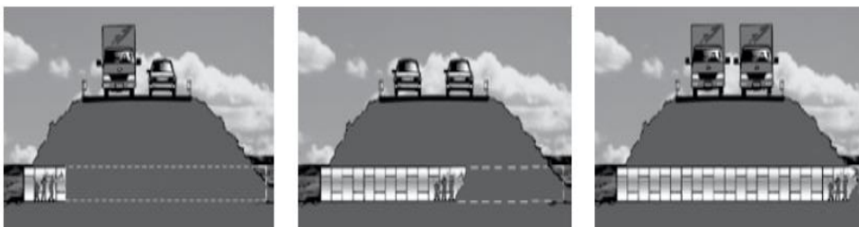
Figura 6 – Ilustração das etapas de construção de um Tunnel Liner
