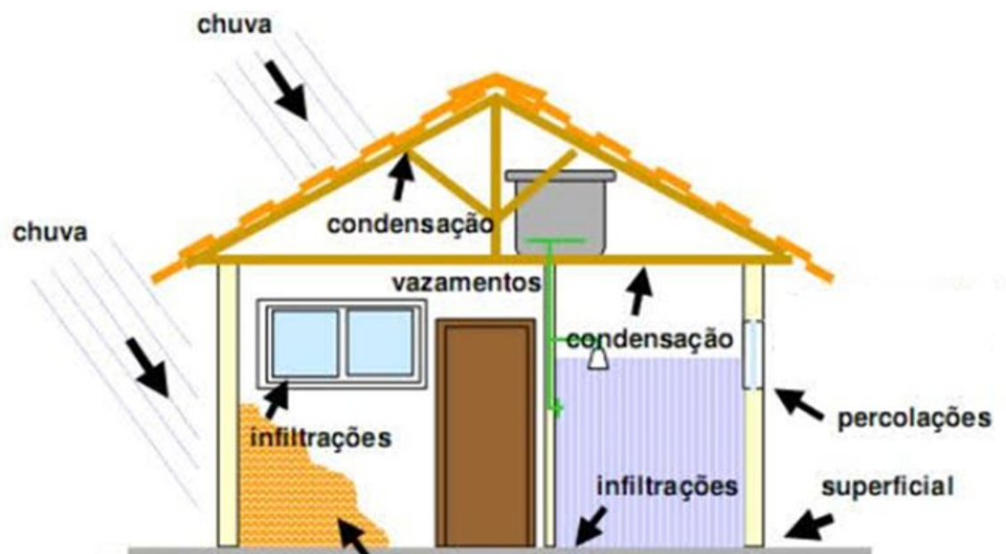
Figura 01- Exemplificação das principais causas das patologias geradas
