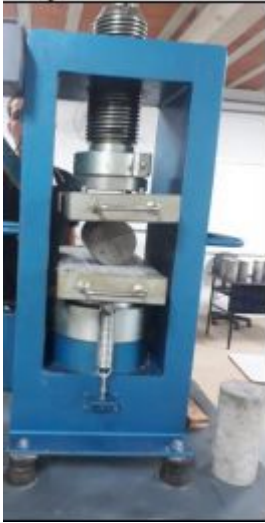
Figura 4: Corpos de provas sendo rompidos à tração por compressão diametral.
