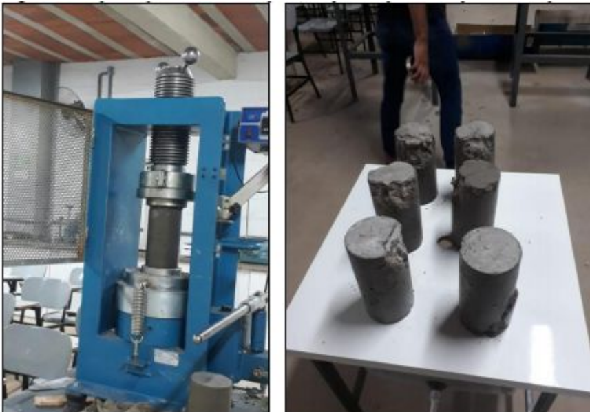
Figura 3: Corpos de prova sendo rompidos à compressão.
