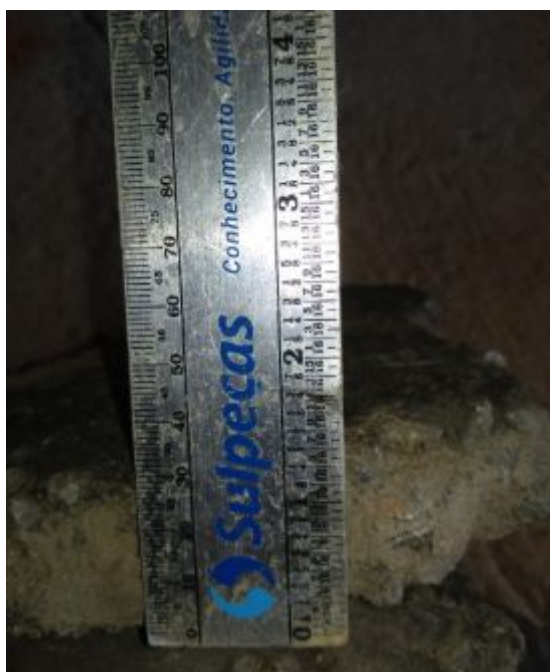
Figura 15: espessura do pavimento
