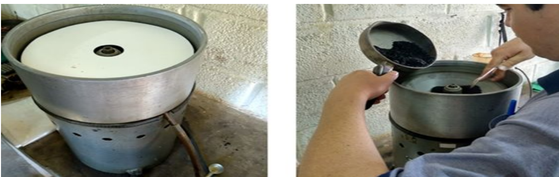
Figura 12: inserção da amostra no Rotarex
