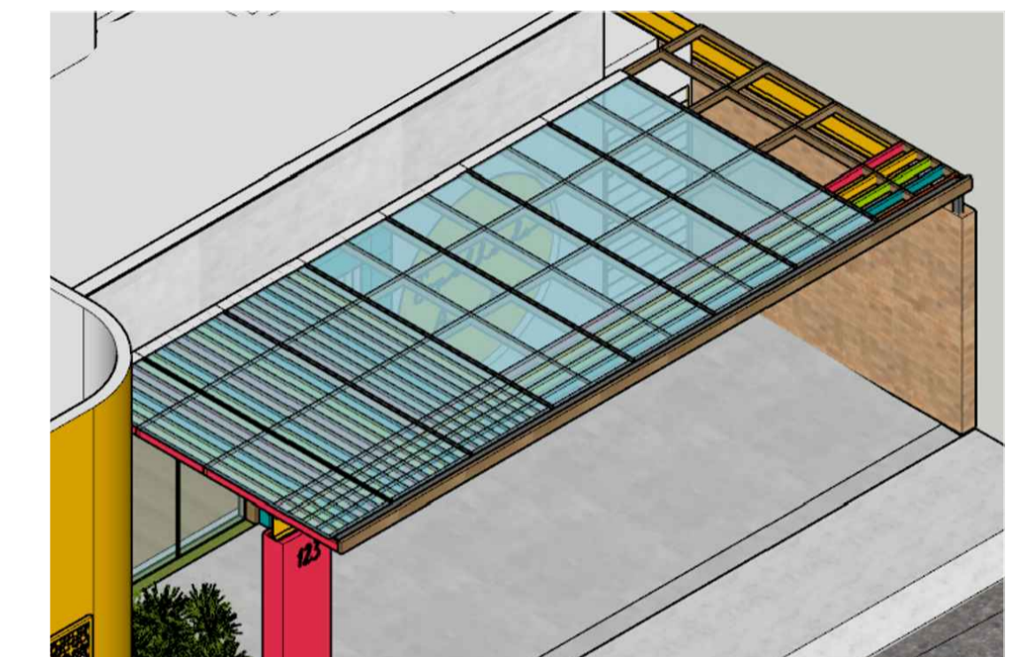
PERSPECTIVA ISOMÉTRICA COBERTURA PERGOLADO COM COBERTURA EM POLICARBONATO COMPACTO 4MM LEITOSO (VIDE INDICAÇÃO DE MEDIDAS NO DETALHE 1A)
