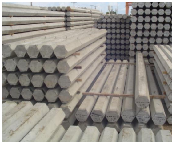
Figura 2.3.1: Confeção das estacas pré-moldadas de concreto
