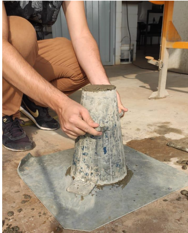
Figura 15: Realização do Slump Test.
