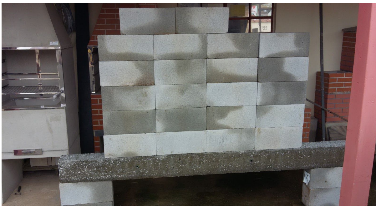
Figura 3 - Ensaio de deslocamento ao longo do tempo para carregamento estático constante.
