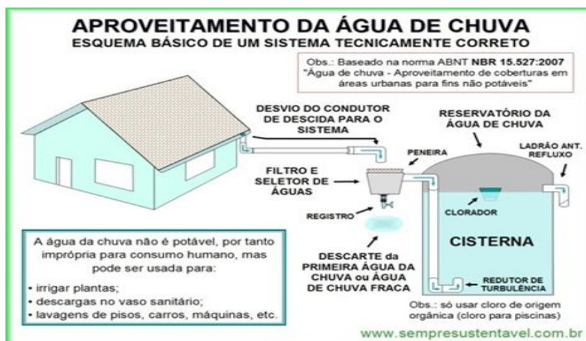
Figura 1: Sistema de aproveitamento de água de chuva
