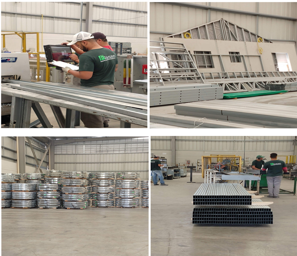
Figura 8 - Visita à empresa especializada em LSF - Framacad, partes semi-montadas, bobinas de aço e perfis
