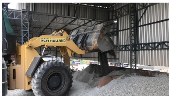
Figura 05 – Pá Carregadeira misturando os materiais
