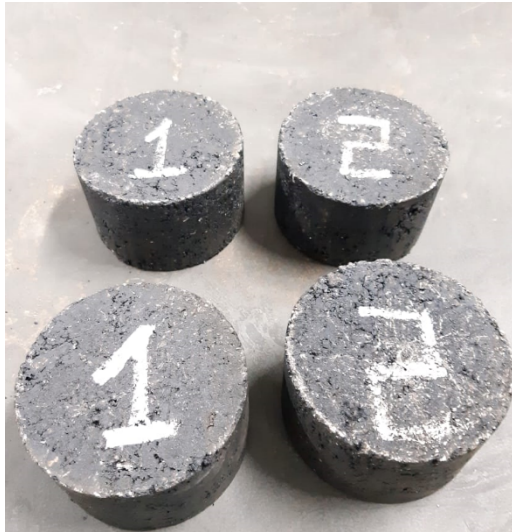
Figura 13 – CPS de asfalto CBUQ
