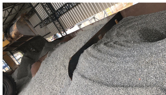
Figura 06 – Monte do estoque de Brita coberto
