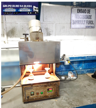
Figura 17 – Equipamento para ensaio de viscosidade SAYBOLT-FUROL
