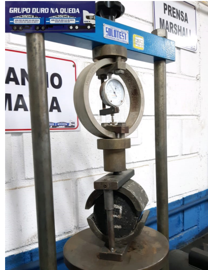
Figura 14 – Rompimento de CPS a compressão
