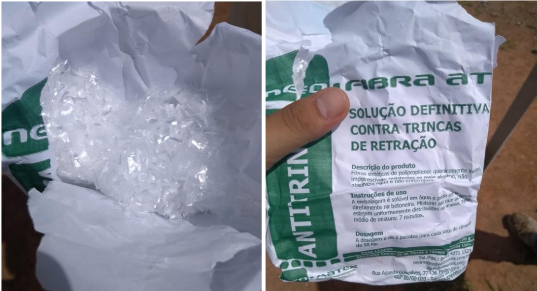
Figura 25: Microfibras de Polipropileno
