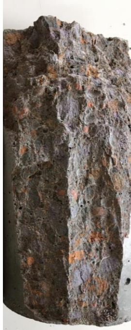
Figura 21: Linha de ruptura por compressão no concreto leve
