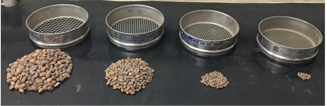
Figura 17: Agregado graúdo retido nas peneiras
