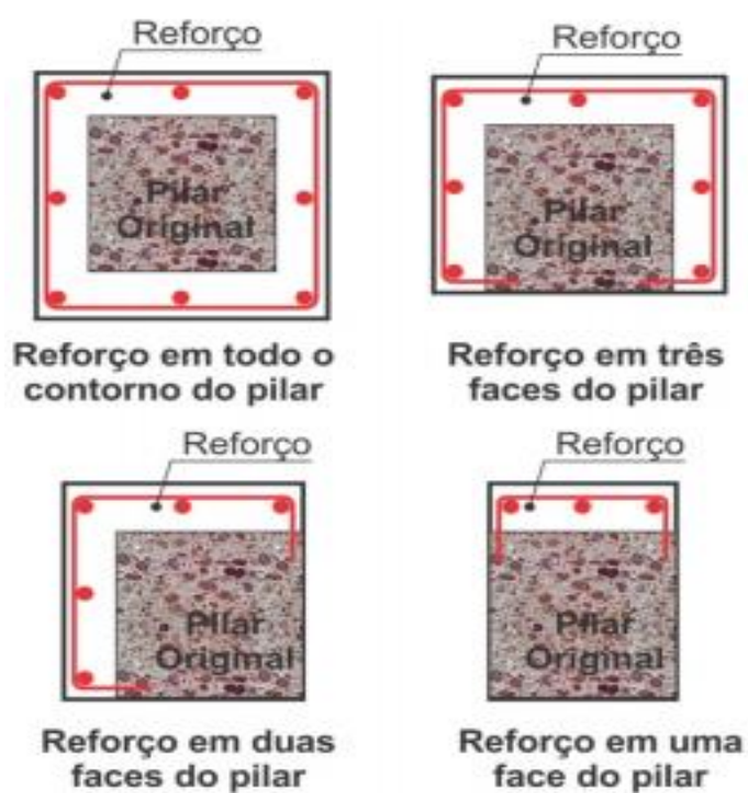
Figura 55: Tipos de configurações de reforço de pilares.
