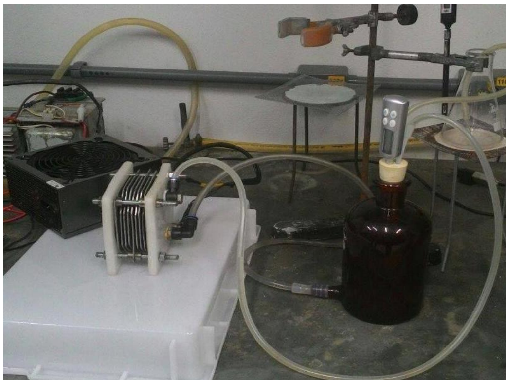
Figura 7 - Gerador de hidrogênio em bancada.
