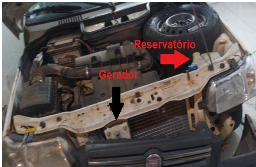
Figura 8 - Gerador de hidrogênio aplicado ao carro
