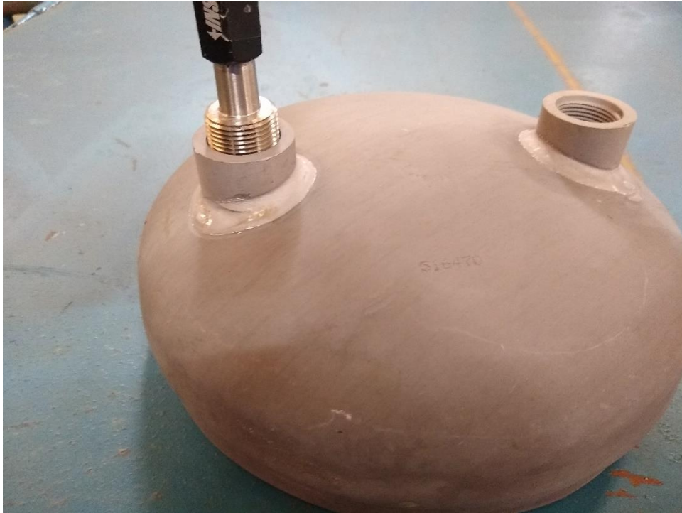
Figura 22 – Exemplo de calota soldada com o melhor parâmetro, porém reprovada
