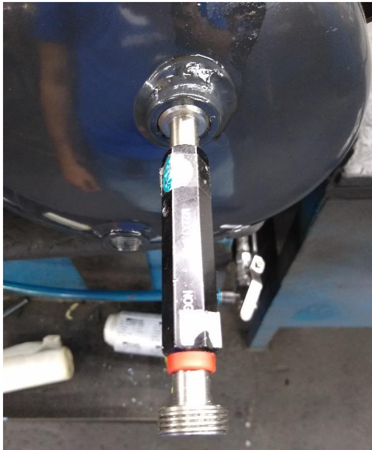
Figura 9 – Verificação da calibragem da rosca
