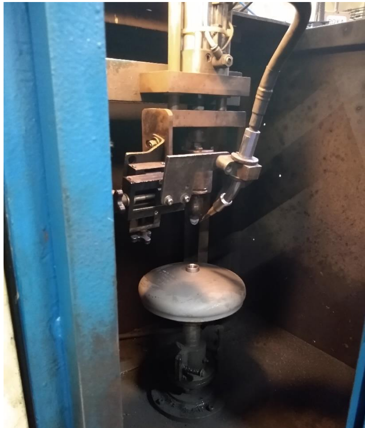
Figura 3 – Imagem interna do dispositivo de solda automática
