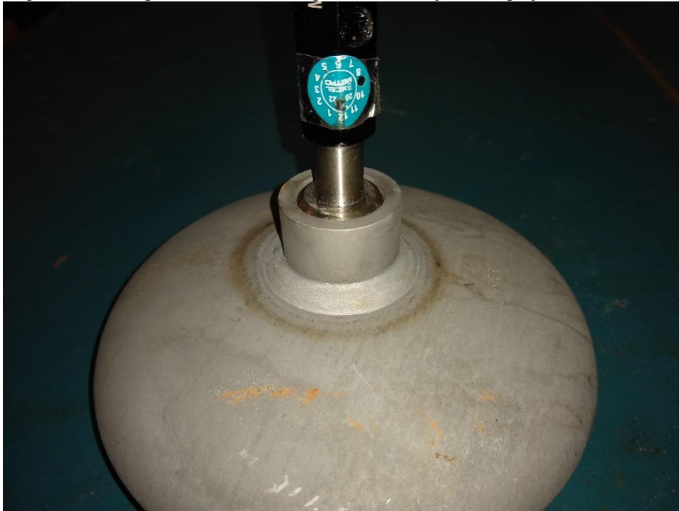
Figura 24 – Exemplo de calota soldada que atendeu o objetivo do projeto
