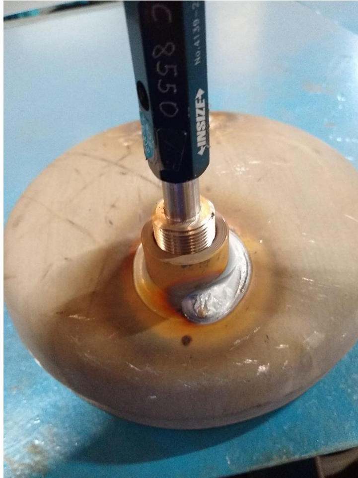
Figura 11 – Teste do calibrador em uma calota de linha sem mudança do projeto
