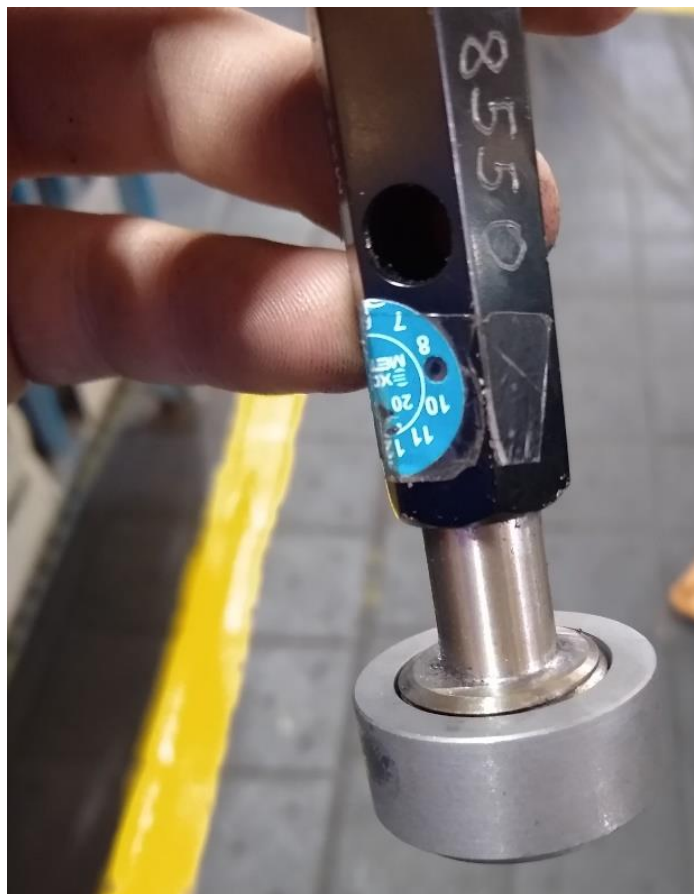
Figura 10 – Demonstração de rosca do flange calibrado antes da solda de união a calota
