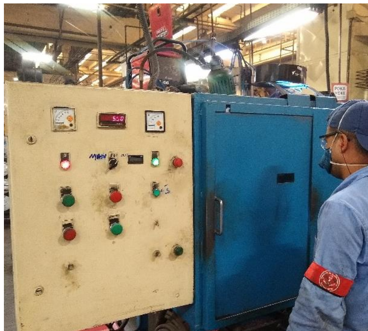
Figura 2 – Dispositivo para solda automática de flange em calotas
