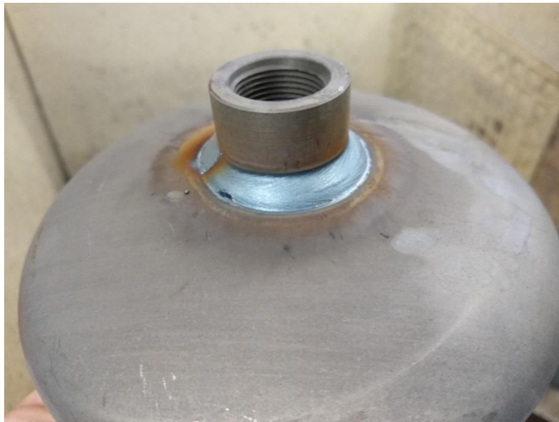
Figura 13 – Amostra da melhor solda obtida na primeira etapa
