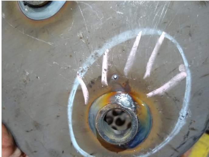
Figura 15 – Exemplo 1 de parâmetro de solda sem sucesso
