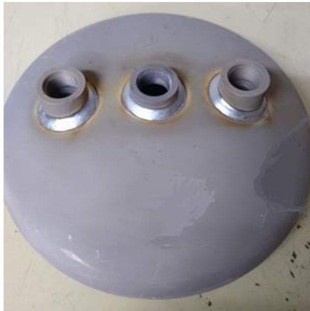
Figura 19 – Melhor solda obtida na segunda etapa
