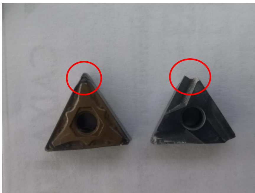
Figura 24 – Pastilhas com falhas críticas
