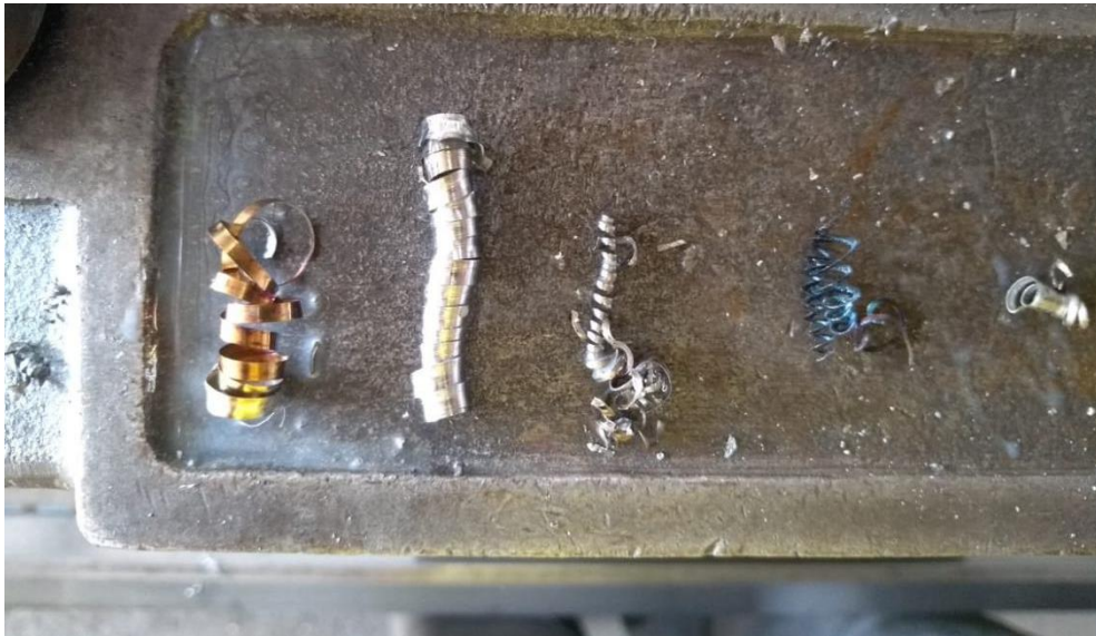
Figura 5 – Tipos de cavacos
