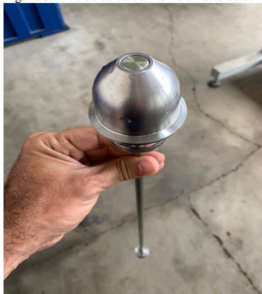
Figura 8: Bico de saída do molho e haste de controle (válvula)
