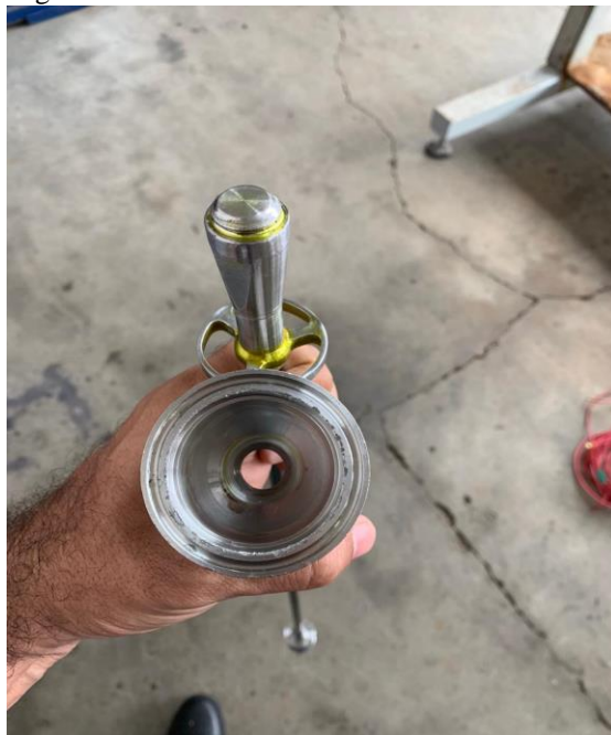
Figura 7: Bico de saída do molho e haste de controle (válvula)
