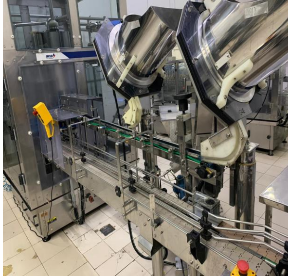
Figura 11: Saída da envasadora e alimentadores de tampas
