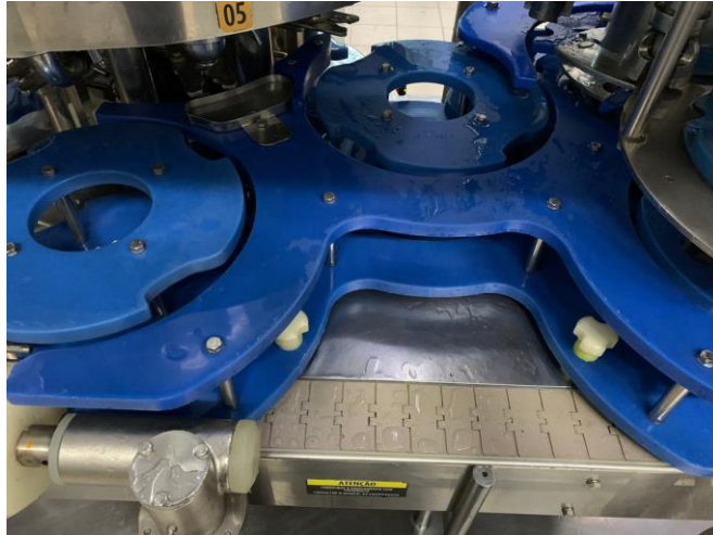
Figura 3: Estrela com o kit para frasco específico
