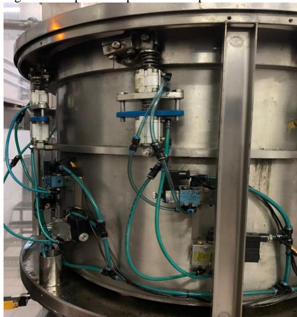
Figura 6: Dispositivos pneumáticos para abertura da válvula
