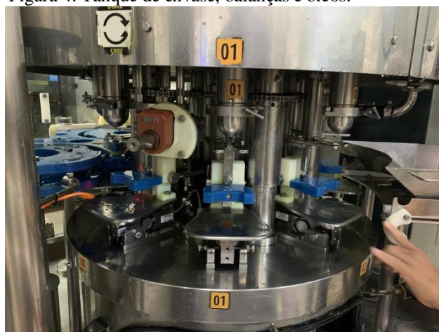
Figura 4: Tanque de envase, balanças e bicos.
