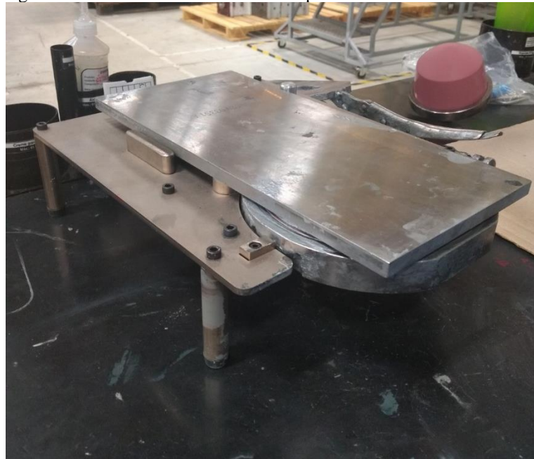
Figura 15 - Encaixe do clichê sobre o copo
