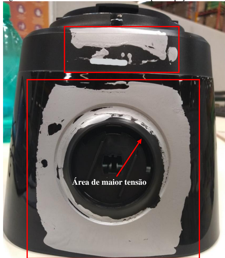
Figura 21 - Análise de área de contato do tampão na peça
