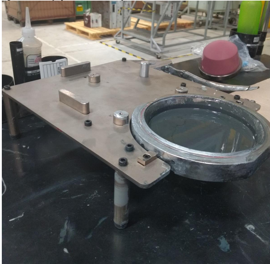
Figura 14 – Berço para encaixe do copo e do clichê
