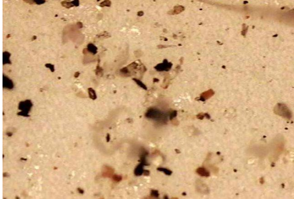
Figura 10 - Partículas sólidas presentes em uma análise de óleo
