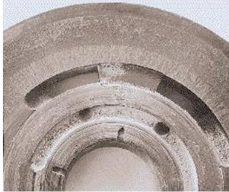
Figura 08 - Desgaste de bomba devido ação da água
