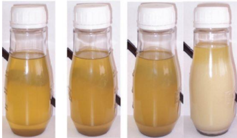
Figura 09 - Efeitos visuais da água no óleo
