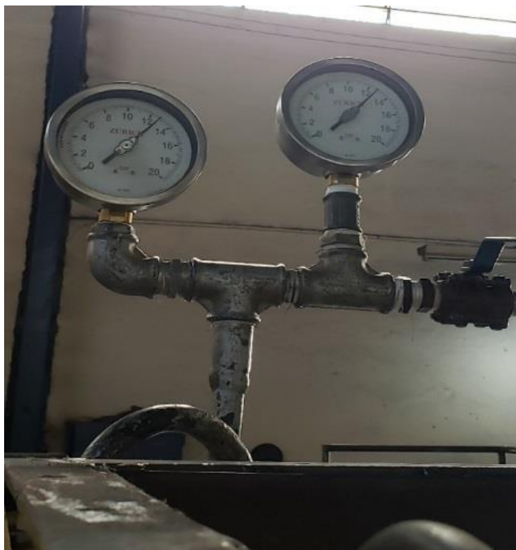
Figura 12: Teste hidrostático da caldeira flamotubular
