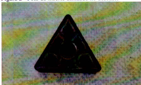
Figura 2 - Foto do inserto utilizado no desbaste
