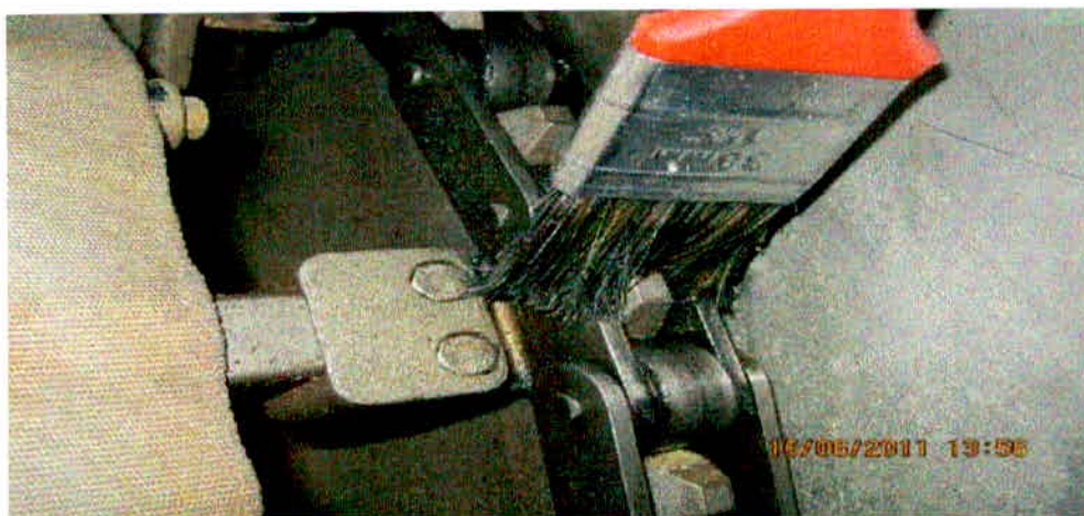
Figura 04: Lubrificação manual das correntes dos pisos de secagem
