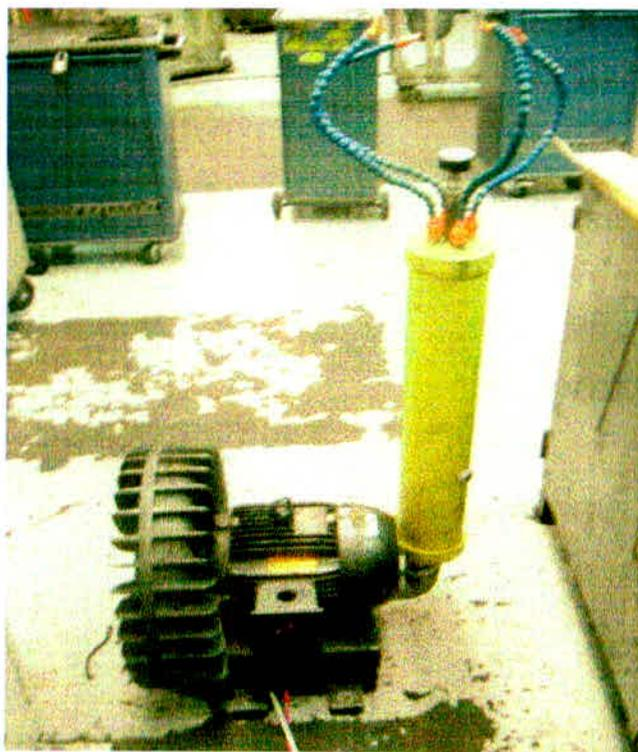
*Foto 14 – Foto compressor radial com bicos. Fonte: O autor*
