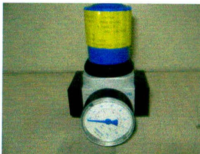
*Foto 12 – Foto válvula reguladora de pressão com manômetro. Fonte: O autor*
