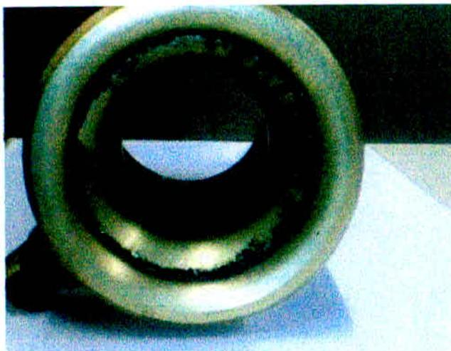
*Foto 16 – Foto micro esferas de vidro depositadas no amplificador de ar. Fonte: O autor*
