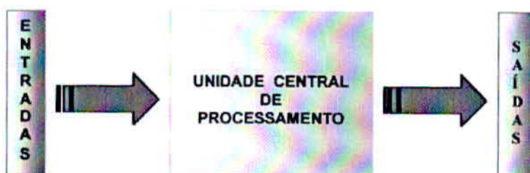
Figura 30 - Estrutura básica de um PLC
