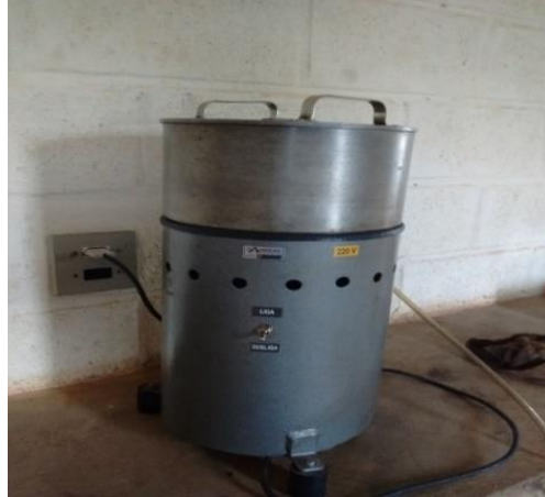
Figura 33– Equipamento Rotarex, extraindo betume
