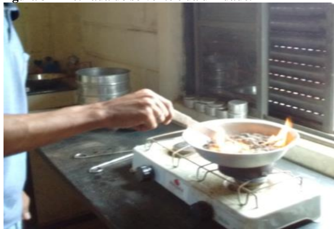
Figura 34– Retirada do solvente e da umidade.
