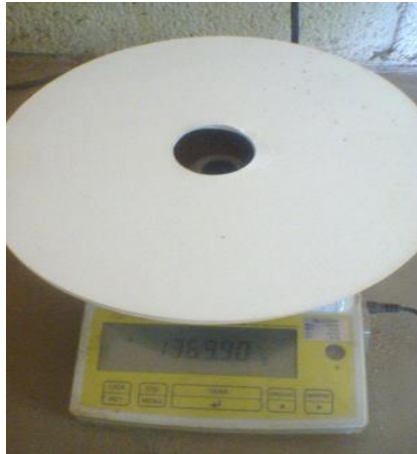
Figura 32- Extrator de betume sendo pesado.
