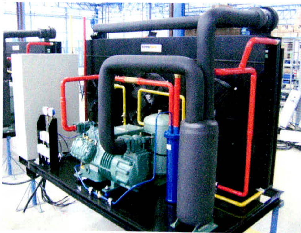
Figura 22: Unidade condensadora montada na empresa Klimaquip – Tecnologia do Frio.
