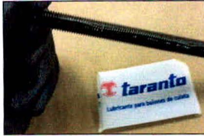
Figura 26: Lubrificação da rosca antes de torqurear.
