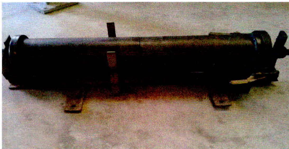
Figura 12- Molde do tubo de ricota da rotomoldagem
