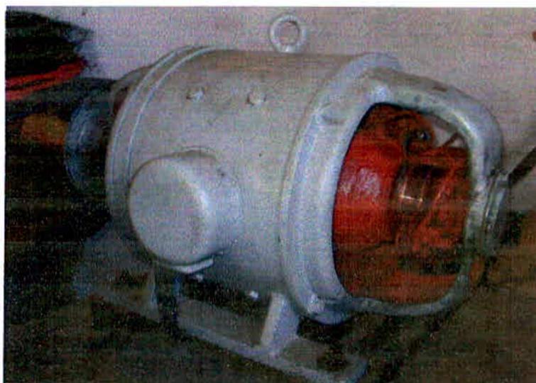
*Foto 11: Exemplo de gerador de micro central hidrelétrica*
