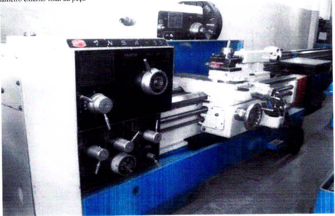
Figura 13 – Torno convencional modelo INSA 30 marca NARDINI, utilizado para colocar a medida correta no diâmetro externo final da peça
