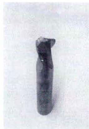
Figura 21 – Desgaste no gume da fresa de metal duro com revestimento de TiN (a), e no gume da fresa de aço rápido (b)
