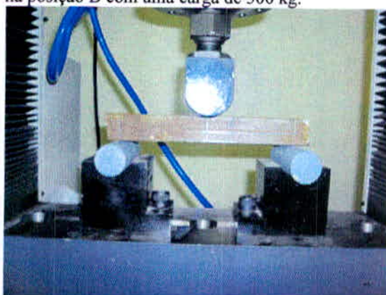
Figura 19 - Inspeção visual do corpo de prova na posição B com uma carga de 500 kg.
