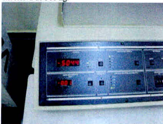
Figura 13 - Painel de controle indicando a carga excessiva de 500 kg.
