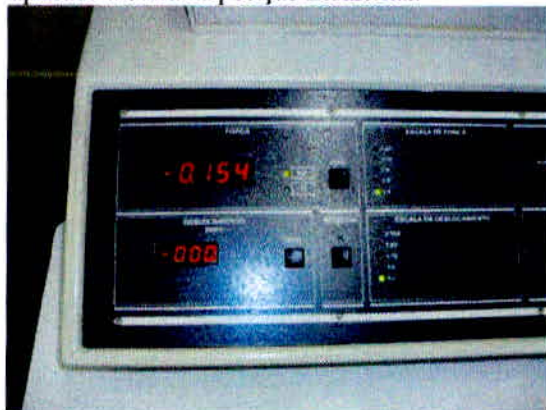
Figura 12 – Painel de controle indicando a carga aplicada à barra na posição horizontal.
