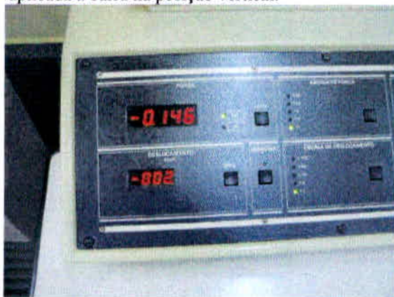
Figura 16 – Painel de controle indicando a carga aplicada à barra na posição vertical.
