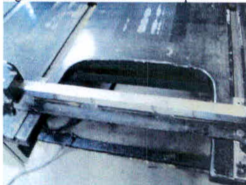
Figura 03 – Abertura em “U” e dispositivo.
