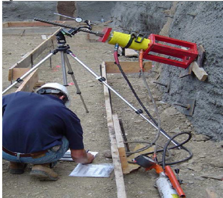
Figura 3.12: Ensaio de arrancamento em curso
