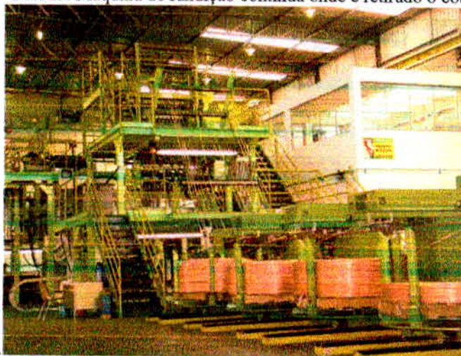
Foto13: Máquina de fundição contínua onde é retirado o cobre OF
