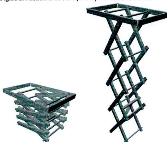
Figura 25: Estrutura de elevação da plataforma elevatória
