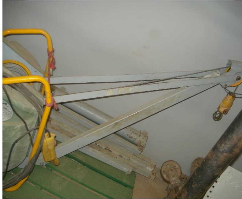
Figura 10- Guincho elétrico para transporte vertical de materiais
