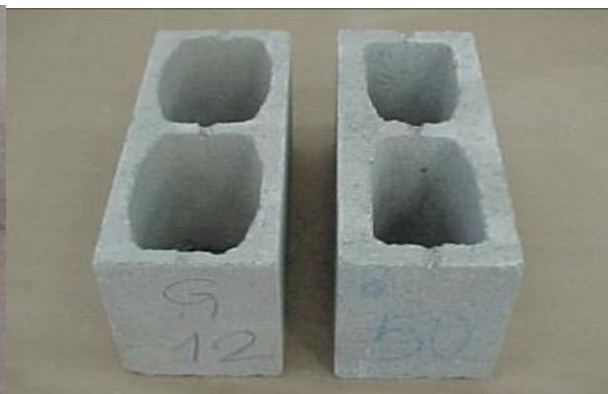
Figura 15- Bloco concreto normatizado
