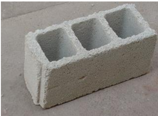
Figura 14- Bloco concreto não normatizado
