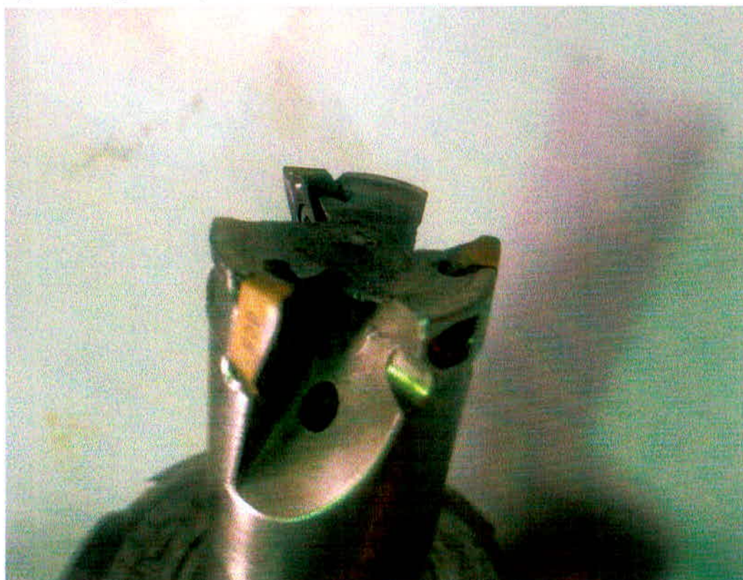
Figura 23- Desgaste dos 3 primeiros minutos de teste
