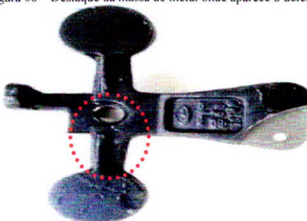
Figura 06 – Destaque da massa de metal onde aparece o defeito
