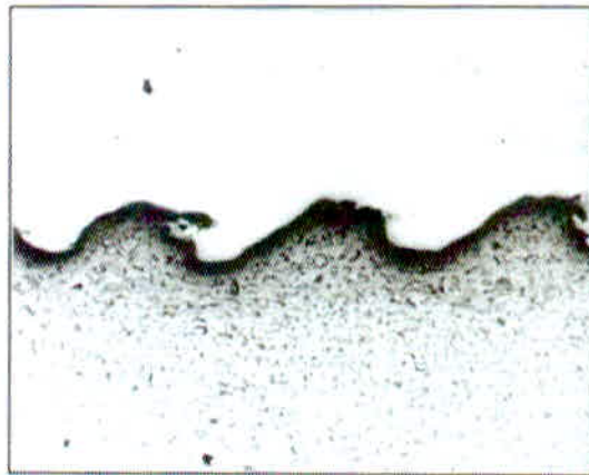
Figura 11 – Micrografia da união de chapas por explosão. Fonte: Introdução aos processos de soldagem (P.V. 2011)
