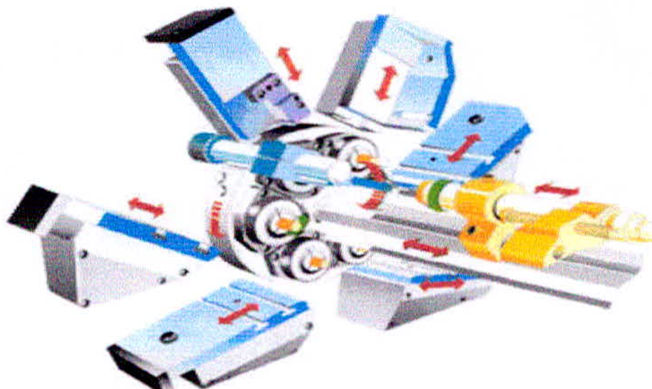
Figura 6 - Ilustração da árvore de um torno multifuso
