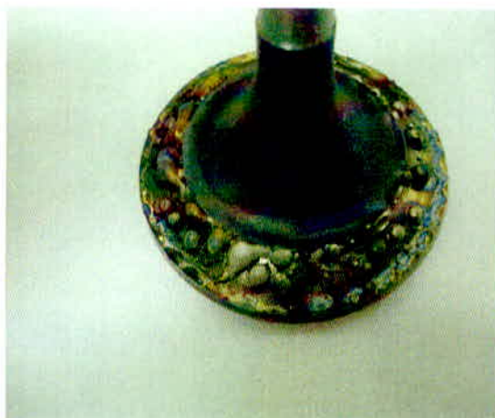
Figura 24: Não diluição dos materiais. Fonte: O autor
