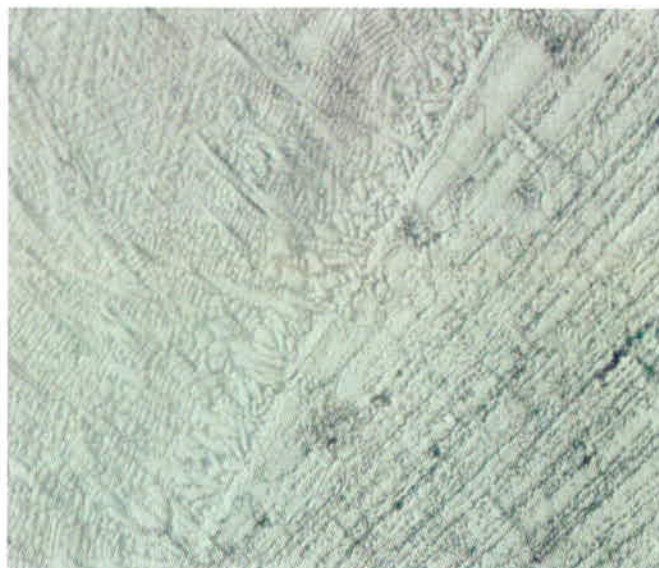
Figura 35: Caldeamento isento de falhas. Fonte: O autor.
