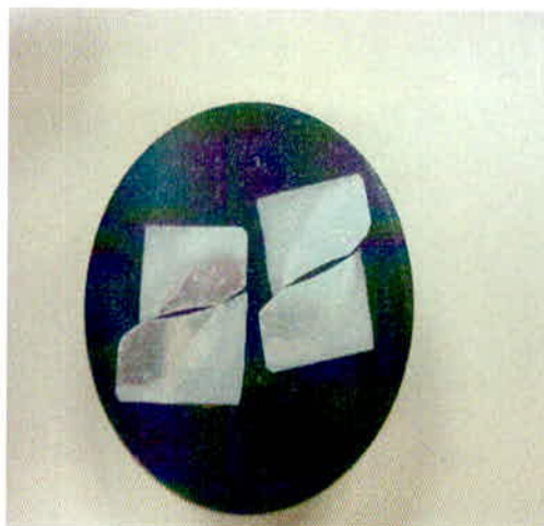
Figura 23: Amostra metalografica (embutida em baquelite) mostrando a profundidade de penetração.
