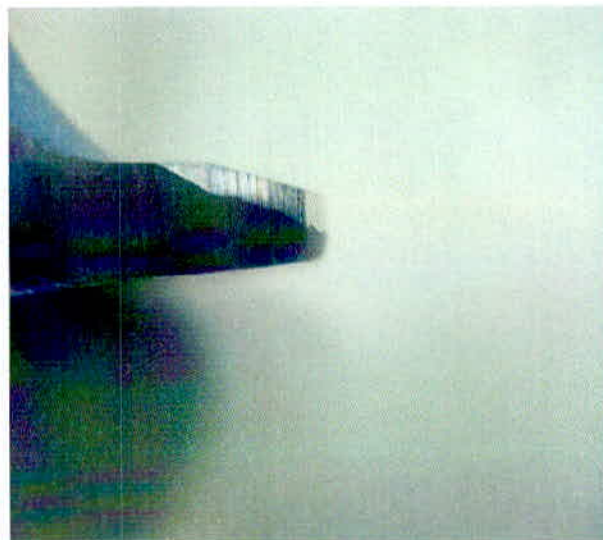
Figura 38: Penetração da solda na peça número 06. Fonte: O autor.
