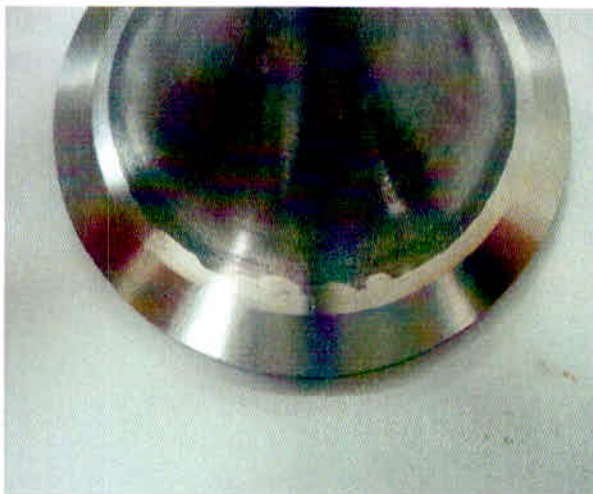
Figura 31: Diluição do material na face inferior na peça número 05 Fonte: O autor.
