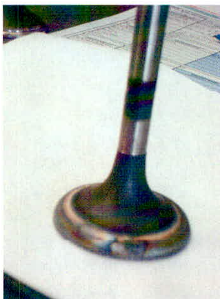
Figura 13: Válvula após soldagem.
