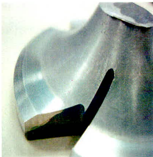
Figura 16: Diluição da solda no perfil. Fonte: O autor.
