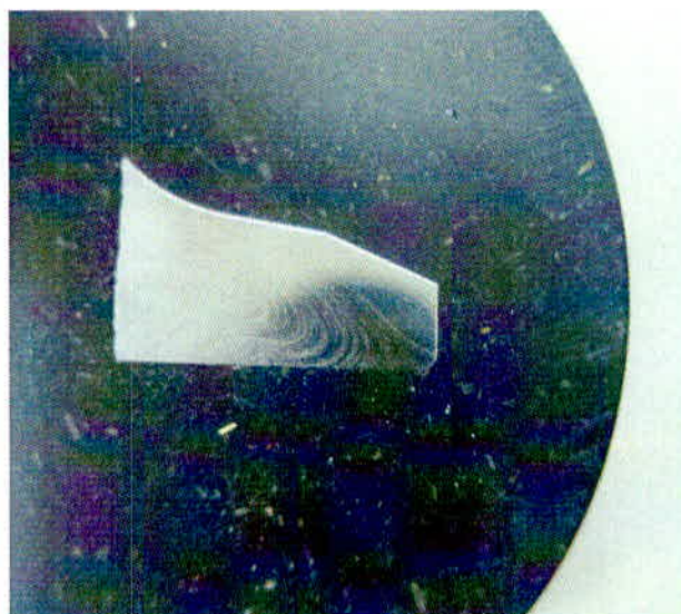
Figura 43: Amostra metalográfica (embutida em baquelite) mostrando a profundidade de penetração. Fonte: O autor.
