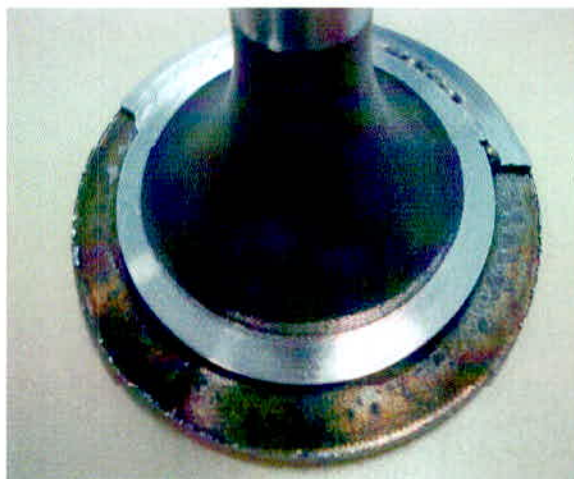
Figura 25: Solda fria na válvula número 03. Fonte: O autor.
