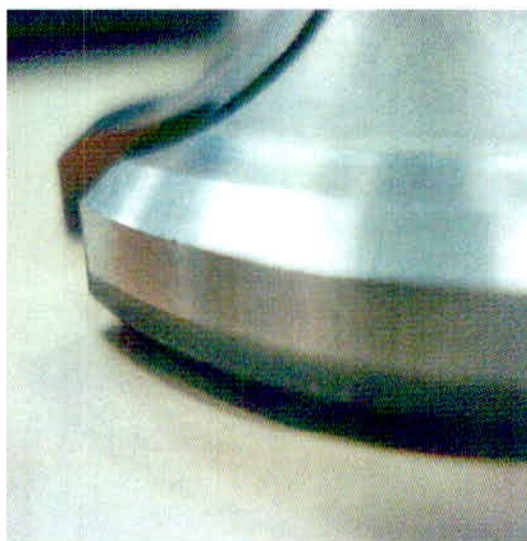
Figura 17: Profundidade de penetração da solda na margem. Fonte: O autor.
