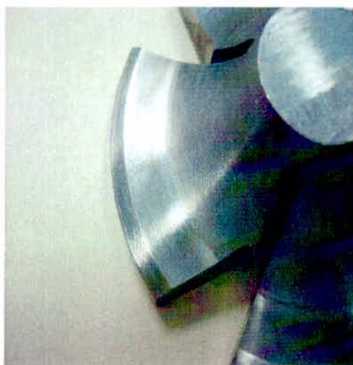
Figura 22: Diluição do material de adição no perfil da válvula. Fonte: O autor.
