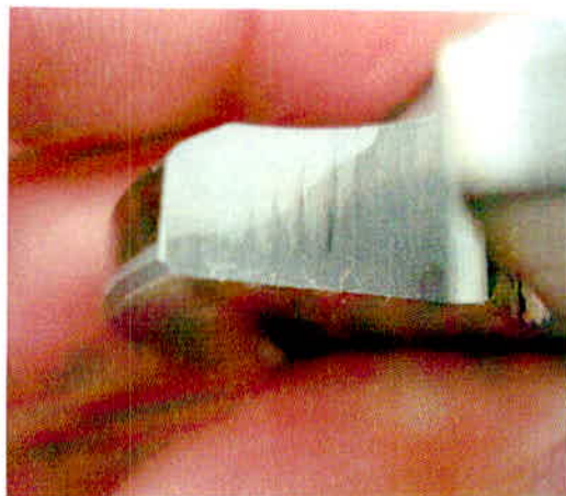
Figura 21: Penetração da solda na sede. Fonte: O autor.
