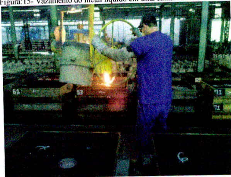
Figura: 15- Vazamento do metal liquido em uma caixa de molde.
