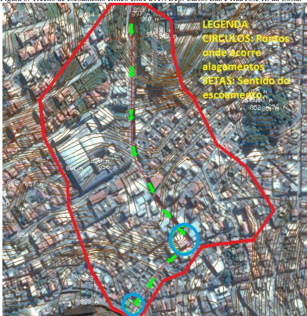
Figura 3: Trecho de escoamento crítico entre a Av. Dep. Carlos Luz e Rua José H. da Costa.
