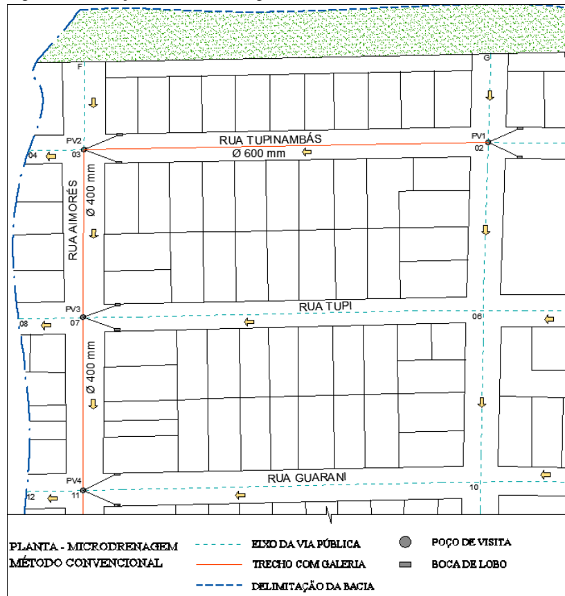
Figura 16 – Traçado das redes de galerias
