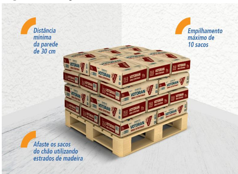
Figura 46: Estocagem ideal de cimento em canteiro de obras.
