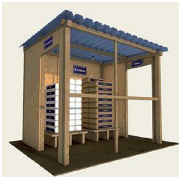
Figura 08: Estocagem de cimento em obra.
